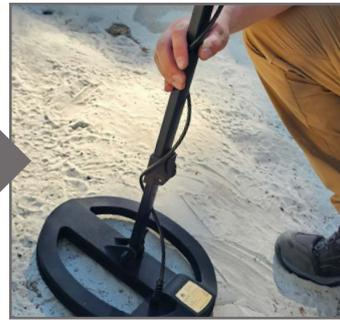
3 Kabel straff um das Teleskopgestänge wickeln, um beim Suchvorgang Fehlsignale zu vermeiden.
