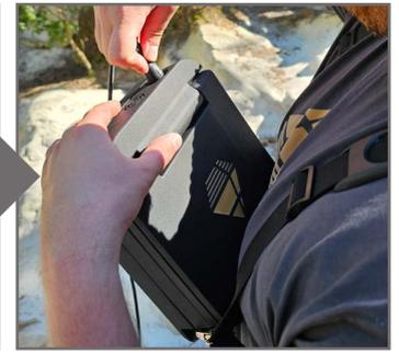
4 Kabel anschließen: Weiße Markierungen ausrichten, Stecker hineindrücken und Steckerkappe im Uhrzeigersinn drehen.
