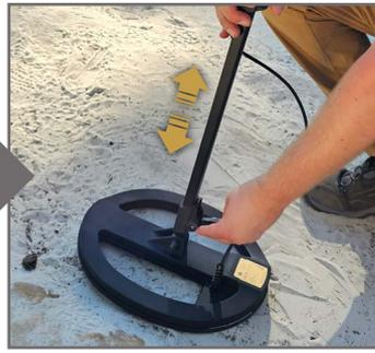
2 Länge des Teleskopgestänges an eigene Körpergröße anpassen.
