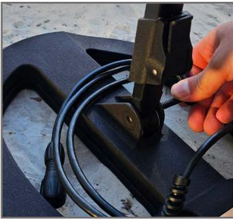
1 PentaCoil am Teleskopgestänge befestigen.
