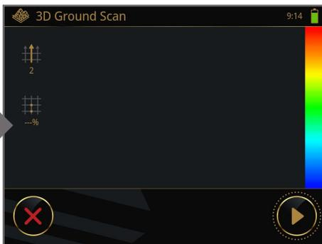
4 Zum nächsten Startpunkt gehen. Drehknopf (oder ► auf dem Display) drücken, um die neue Messbahn zu scannen. Diese Messbahn stoppt automatisch.
