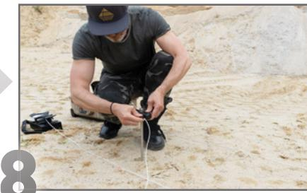
8 Spannungs-Elektroden platzieren und verbinden (schwarze Stecker).
