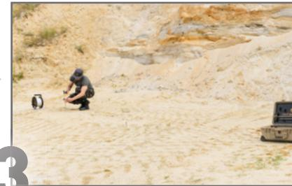
3 Strom-Kabeltrommeln bis zur angezeigten Markierung (App) ausrollen.
