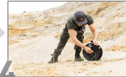
4 Strom-Elektroden an Markierung platzieren, Kabeltrommel verbinden.
