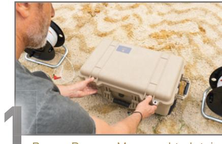
1 Power Box am Messpunkt platzieren, öffnen und Antenne ausklappen.
