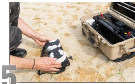
5 Controller mit 1 m Abstand zur Power Box am Messpunkt platzieren.
