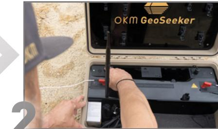
2 Strom-Kabeltrommeln verbinden (rote Stecker/Buchsen).
