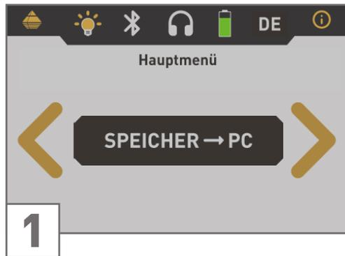
1 Schalten Sie das Gerät ein und wählen Sie im Hauptmenü die Betriebsart "Speicher an PC". Drücken Sie die Taste **OK**, um den Bildschirm für die Speicherbereiche zu öffnen
