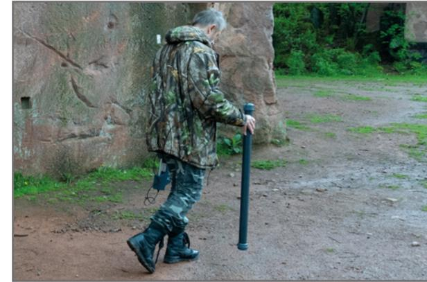
Drücken Sie die Taste **▶▶**, um die Abtastung des Untergrunds zu starten. Bewegen Sie die Supersonde langsam von einer Seite zur anderen über das gewünschte Objekt. Versuchen Sie, das gesamte Objekt zu erfassen, d. h. messen Sie über die Kanten des Objekts hinaus. Wiederholen Sie diese Messung ein paar Mal, um eine eindeutige Signatur des Objekts zu erhalten. Während dieses Vorgangs sollte die Supersonde senkrecht zum Boden zeigen.
