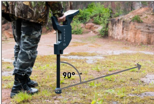
Bewegen Sie sich langsam vorwärts, rückwärts und seitwärts, aber vermeiden Sie es, die Sonde zu drehen. Die Sonde sollte immer senkrecht zum Boden zeigen. NICHT schwenken, schwingen oder um die eigene Achse drehen.
