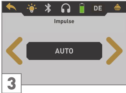
Stellen Sie die Anzahl der Messpunkte (Impulse) ein, die für jede einzelne Scanbahn aufgezeichnet werden sollen.
