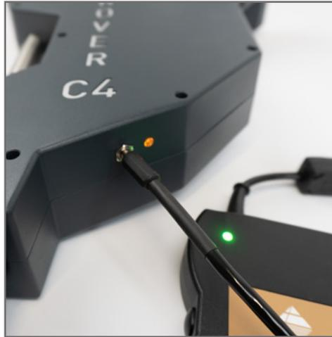
Alternativ können Sie den Detektor auch mit dem Power Pack zum Aufladen des Detektors verwenden.
