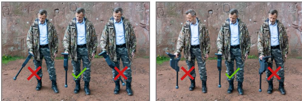
Sobald ein akustisches Signal ertönt, hat das Gerät ein potenzielles Metallziel direkt unter der Position der Sonde erkannt. Auf diese Weise ist es möglich, kleine, oberflächennahe Metallobjekte wie Nägel, Schrauben, Drähte, Dichtungen und ähnliche Ziele zu finden.
