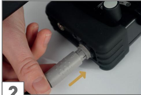
Stecken Sie den Stecker der Suchspule in die dafür vorgesehene Buchse der Kontrolleinheit.
