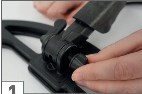
Schrauben Sie die Schraube aus der Suchspulenhalterung des Teleskopgestänges heraus. Achten Sie darauf, dass die Gummischeiben neben dem Schaft sitzen, bevor Sie die Suchspule anbringen.
