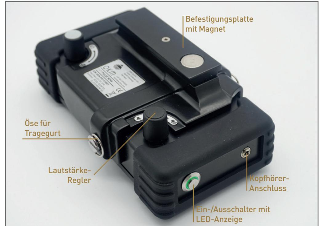
**Befestigungsplatte mit Magnet:** Dieses Teil dient zur Befestigung der Kontrolleinheit am Teleskopgestänge. Dank des eingebauten Magneten bleibt die Kontrolleinheit an ihrem Platz. Lesen Sie das Kapitel „3.2 Kontrolleinheit befestigen“ auf Seite 12, um mehr über die Montage und Demontage der Kontrolleinheit am Teleskopgestänge zu erfahren.
