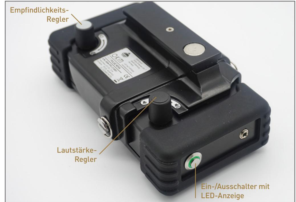
**Ein-/Ausschalter mit LED-Anzeige:** Drücken Sie die Ein-/Aus-Taste, um die Kontrolleinheit einzuschalten. Zunächst beginnt die LED für etwa 2 Sekunden zu blinken, bevor sie dauerhaft **grün** leuchtet. Wenn die LED vor dem Ausschalten schnell blinkt, ist der interne Akku zu schwach und muss aufgeladen werden (siehe Kapitel „3.1 Kontrolleinheit laden“ auf Seite 11).
