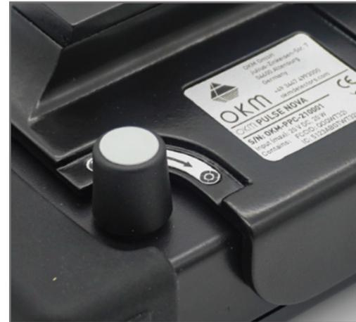
Drücken und halten Sie den Empfindlichkeitsregler der Kontrolleinheit, um einen neuen Bodenabgleich zu starten.
