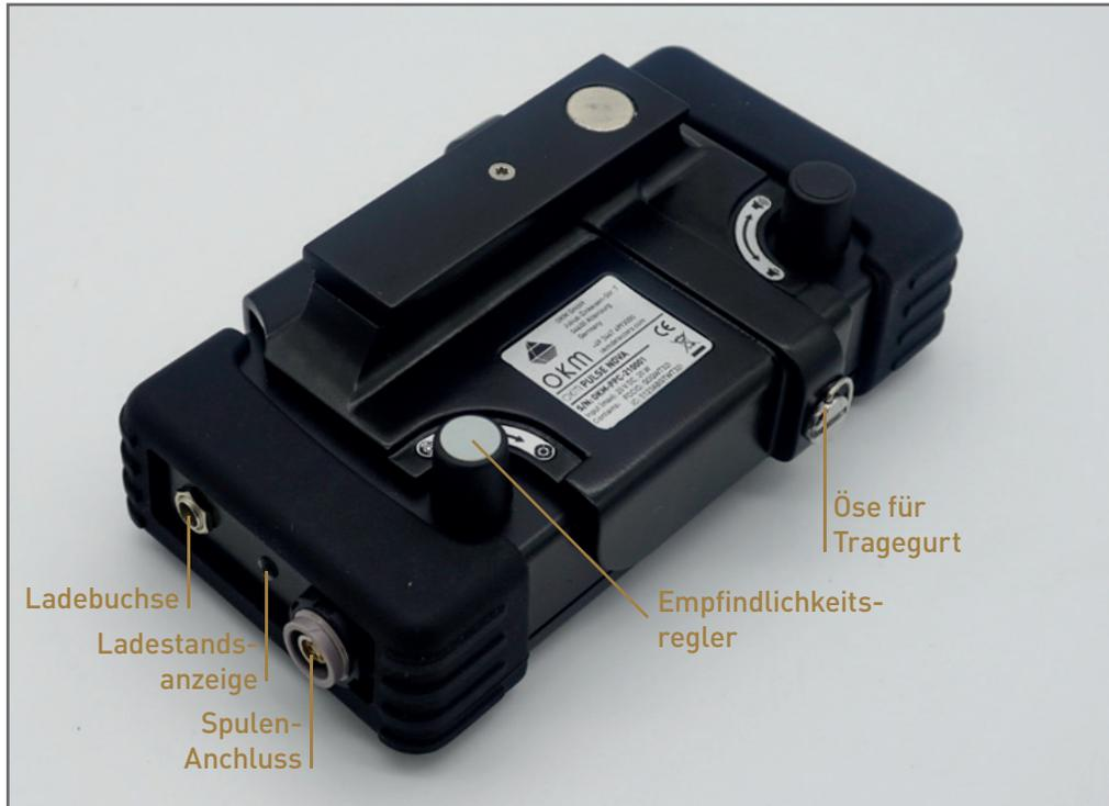
**Ladebuchse / Ladestandsanzeige:** Wenn der interne Akku zu schwach ist, was durch einen Dreifachton in immer kürzeren Abständen signalisiert wird, müssen Sie ihn aufladen, indem Sie das entsprechende Ladegerät an die Ladebuchse anschließen. Solange der Ladevorgang läuft, leuchtet die Ladestandsanzeige **orange**. Sobald die LED erlischt, ist der Akku vollständig geladen. Ausführliche Informationen zum Aufladen des Geräts finden Sie im Kapitel „3.1 Kontrolleinheit laden“ auf Seite 11.
