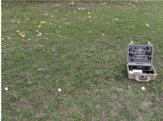
1. Platzieren Sie das Steuergerät an der ersten Abtastpunktmarkierung.
