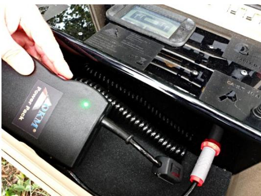
2. Nach dem Einschalten des Power Packs selbst wird auch der GeoSeeker Mini eingeschaltet. Nach kurzer Zeit sollten Sie das Hauptmenü auf dem Display sehen.
