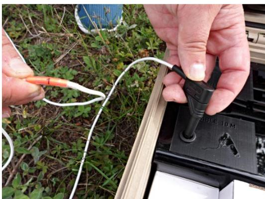
3. Verbinden Sie den ersten Stecker des Spannungskabels mit der Steuereinheit. Achten Sie darauf, das Ende mit der niedrigsten Markierungsnummer "1" zu verwenden.
