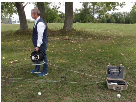
11. Rollen Sie das Kabel der Stromkabeltrommel ab, indem Sie sich von der Steuereinheit wegbewegen, bis Sie die Kabelmarkierung erreichen, die auf dem Messbildschirm Ihres Geräts angezeigt wird.
