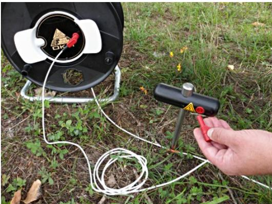
14. Verbinden Sie nun das zweite Ende des Verlängerungskabels mit der Leistungselektrode.
