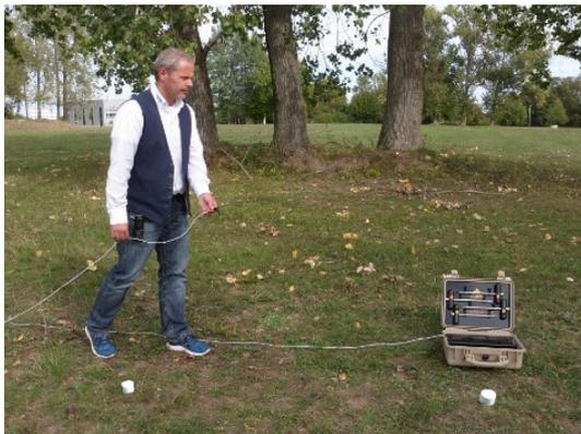
5. Nach Erreichen des Endes machen Sie eine Umdrehung und bringen Sie das Kabel zu der Kabelmarkierung zurück, die auf dem Messbildschirm Ihres Geräts angezeigt wird. Eine vollständige Verlegung des Kabels erleichtert die spätere Neuordnung der Elektroden.
