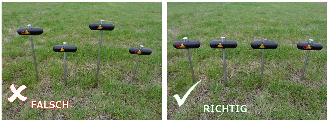
Abbildung 8.2: Elektroden müssen gleichmäßig in den Boden eingelassen werden
