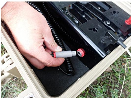
1. Schließen Sie das Netzteil an die entsprechende Steckdose an. Während Sie den Stecker in die Steckdose schieben, drehen Sie den Stecker um, bis er einrastet.
