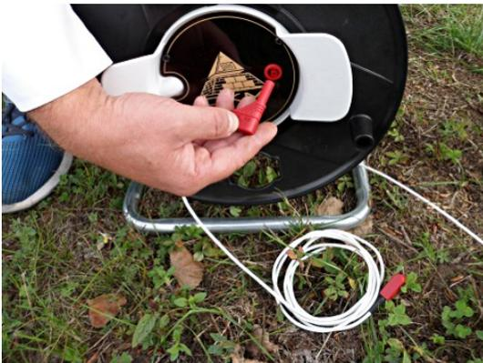
13. Verwenden Sie das Verlängerungskabel (2 m) und schließen Sie es an die Power Drum an.
