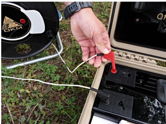
10. Schließen Sie nun den Stecker der ersten Stromkabeltrommel an die entsprechende Buchse der Steuereinheit an.
