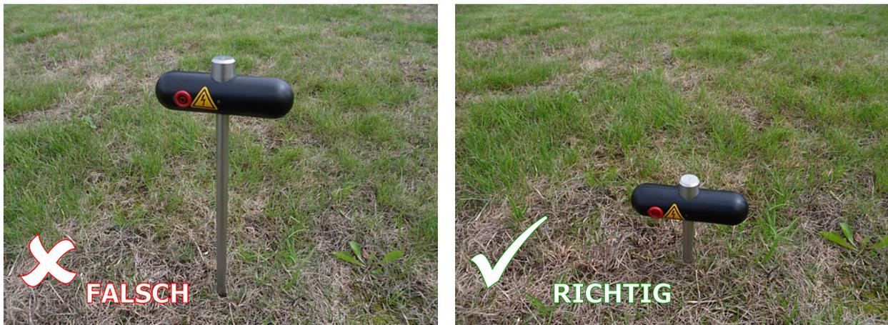
Abbildung 8.1: Elektroden benötigen guten elektrischen Massekontakt
