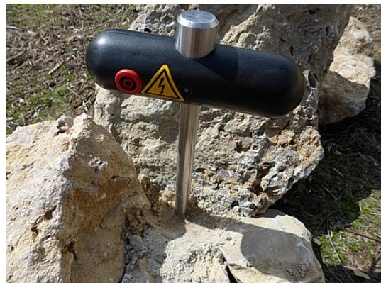
Abbildung 8.5: Bohren eines Lochs und Nachfüllen für die Elektrode
