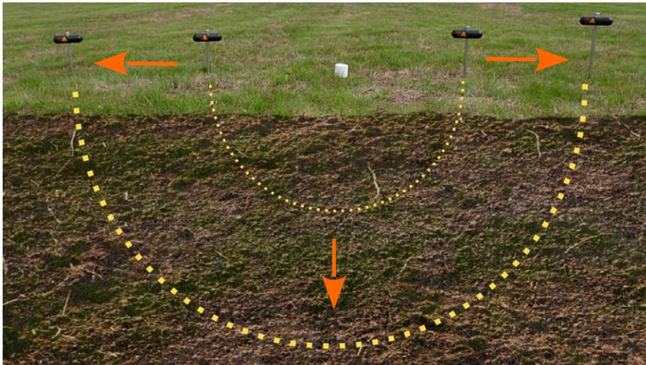
Abbildung 6.3: Leistungsinjektionstiefe hängt vom Elektrodenabstand ab
