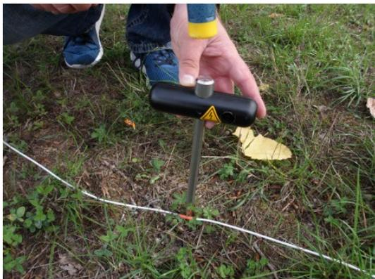
6. Placez l'électrode de tension à côté du marqueur de câble dans le sol aussi profondément que possible. Utilisez un marteau si nécessaire.
