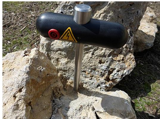
Figure 8.5: Percer un trou et le remplir pour l'électrode
