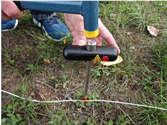
12. Placez l'électrode de puissance à côté du marqueur de câble dans le sol aussi profondément que possible. Utilisez un marteau si nécessaire.
