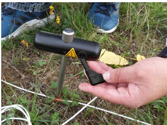
7. Connectez le câble de tension avec l'électrode de tension.
