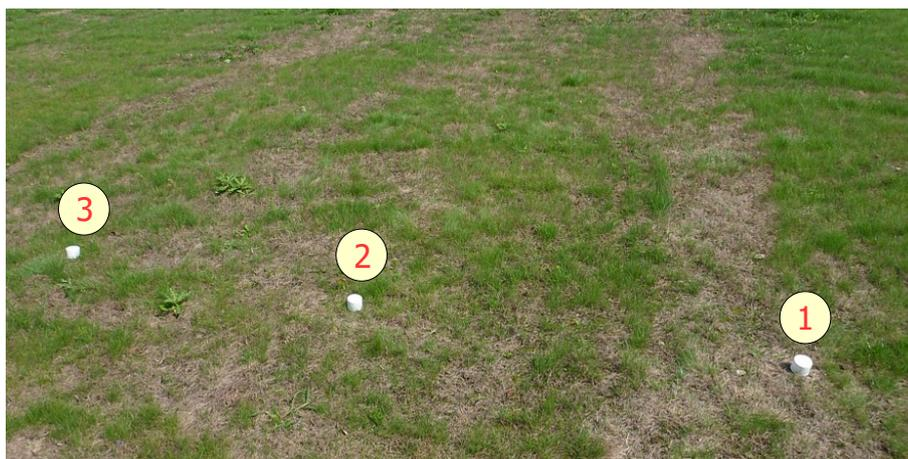
Figure 6.2: Diviser le champ en points de balayage et mettre en place des marqueurs
