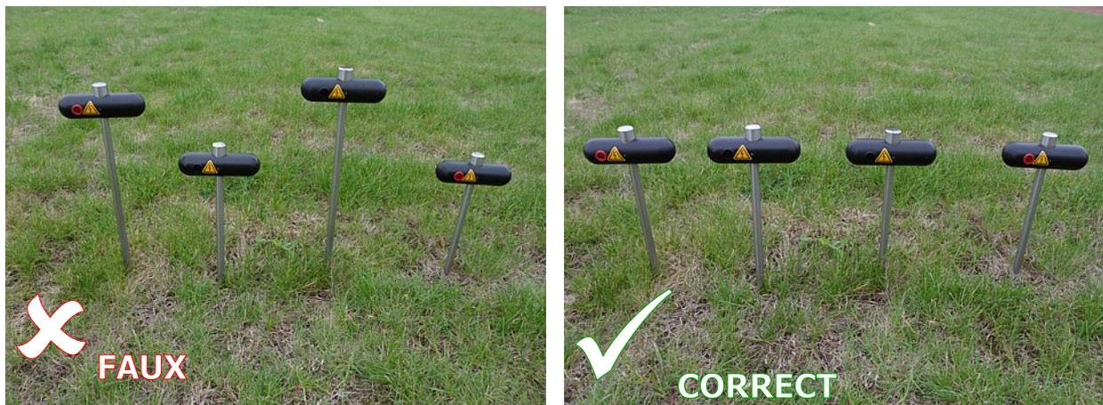
Figure 8.2: Les électrodes doivent être enfoncées dans le sol de la même manière
