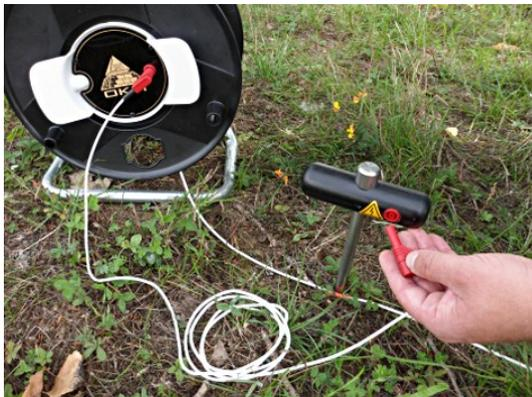
14. Connectez maintenant la deuxième extrémité du câble de rallonge à l'électrode d'alimentation.
