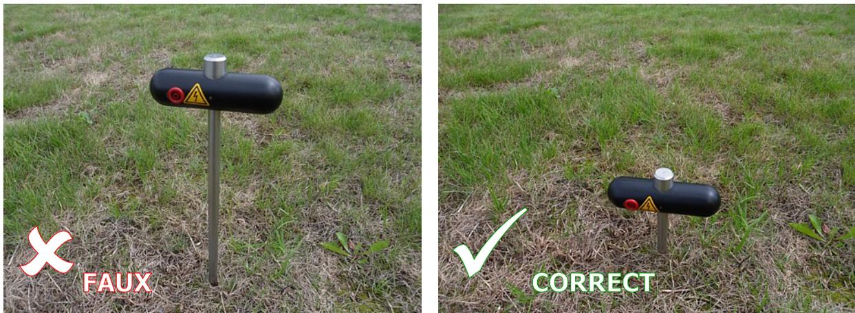
Figure 8.1: Les électrodes ont besoin d'un bon contact électrique avec la terre
