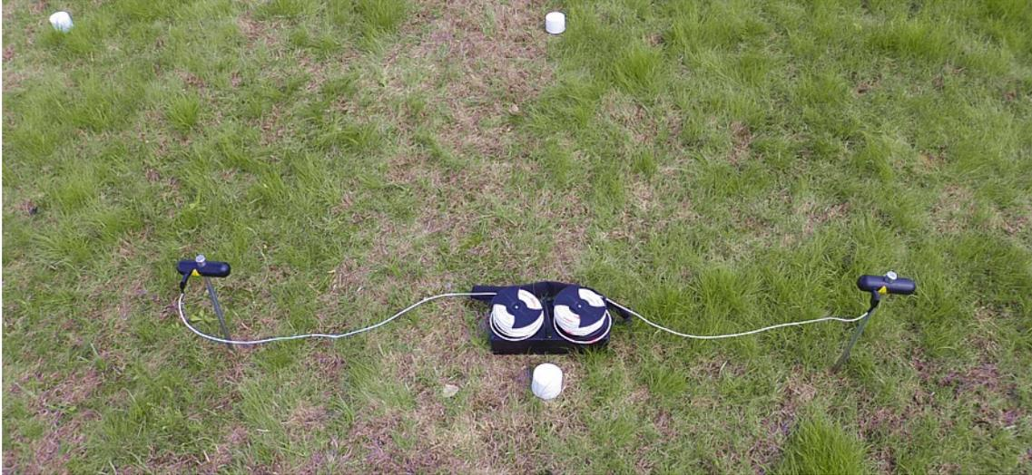
*Figure 7.8: Disposition des électrodes lors d'un scan passif*
