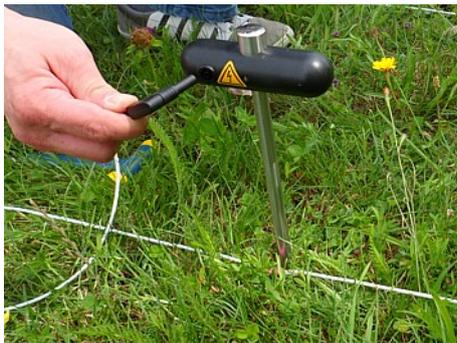
5. Connectez le câble du rouleau Voltage avec l'électrode Voltage.
