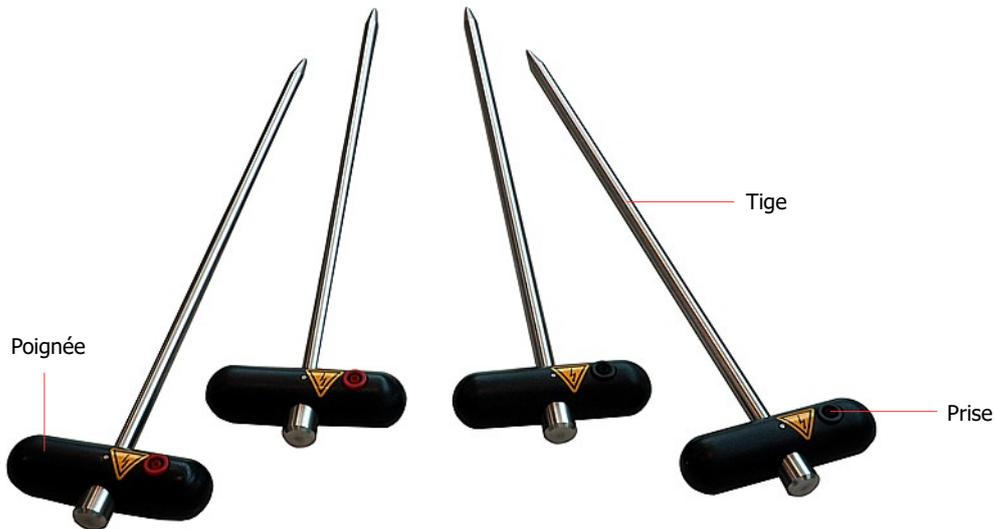
Figure 4.1 : Éléments des électrodes
