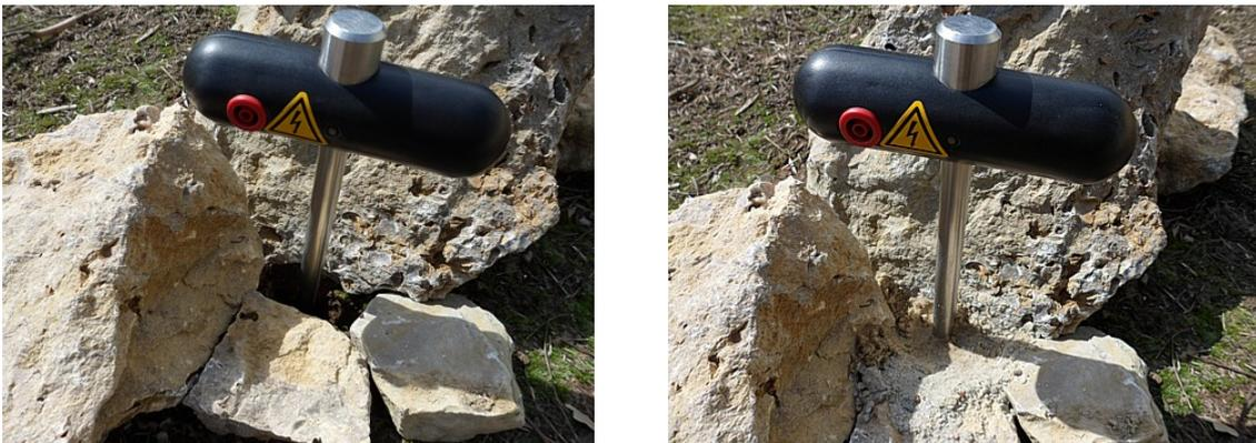
Figure 9.5: Forer un trou et le reboucher avec l'électrode
