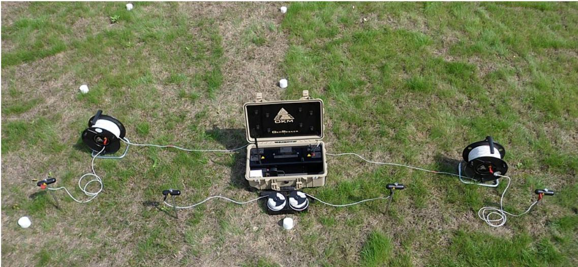
Figure 7.6: Arrangement des électrodes lors d'un scan actif (méticuleux)
