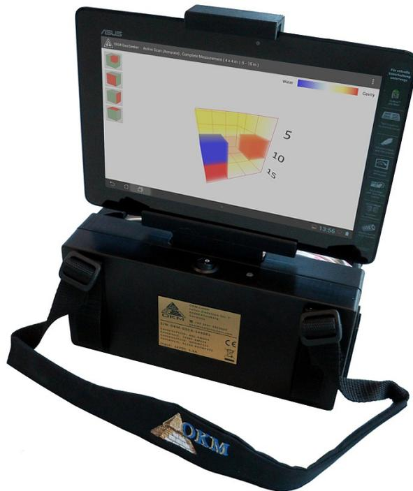
Figure 6.3: Tablette PC montée sur le boîtier de contrôle
