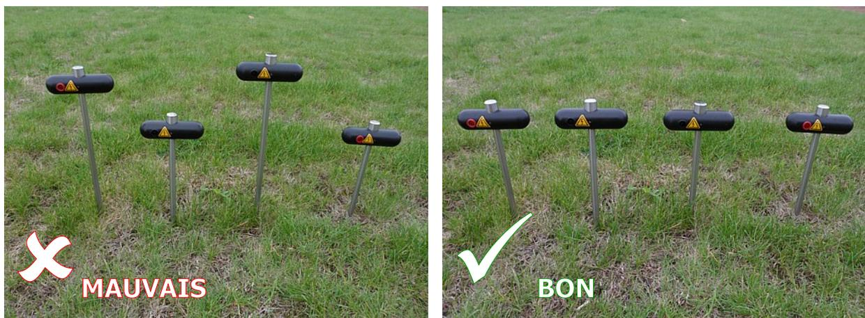
Figure 9.2: Les électrodes doivent être toutes plantées de la même manière
