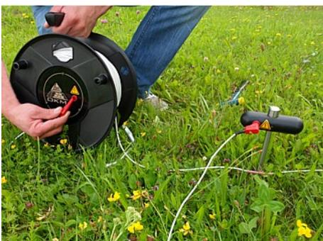
5. Utilisez le câble d'extension pour relier le rouleau de câble d'alimentation avec l'électrode d'alimentation.
