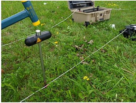
4. Plantez aussi profondément que possible l'électrode Voltage à proximité du repère de câble. Utilisez un marteau si nécessaire.
