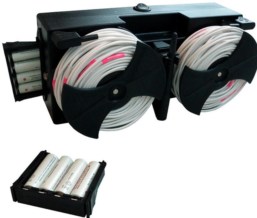
Figure 6.1: Placer les piles dans les compartiments du boîtier de contrôle
