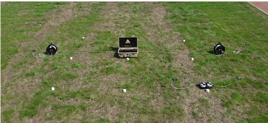
Figure 7.7: Arrangement des électrodes lors d'un scan actif rapide
