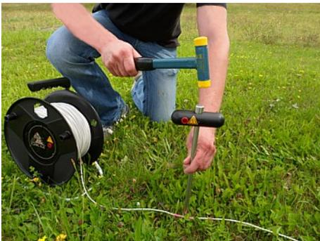
4. Plantez aussi profond que possible l'électrode d'alimentation à proximité du repère de câble. Utilisez un marteau si nécessaire.
