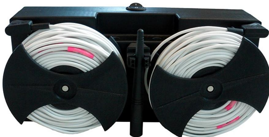
Figure 6.4: Câbles Voltages assemblés sur le boîtier de contrôle
