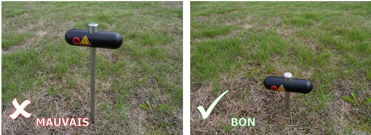
Figure 9.1: Les électrodes ont besoin d'un bon contact électrique avec le sol
