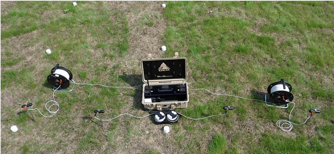
Abbildung 7.6: Anordnung der Elektroden während der Aktiven Messung (Exakt)
