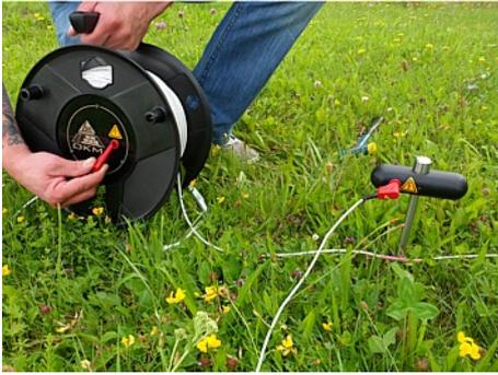
5. Verwenden Sie das Verlängerungskabel, um die Strom-Kabeltrommel mit der Strom-Elektrode zu verbinden.
