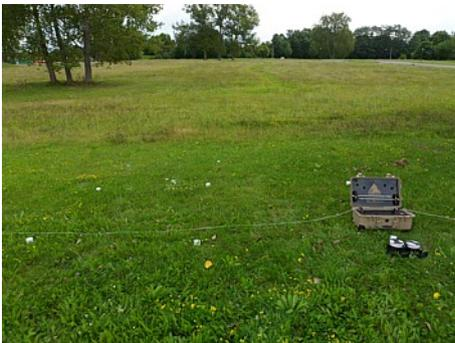
1. Platzieren Sie den Controller am aktuellen Messpunkt.
