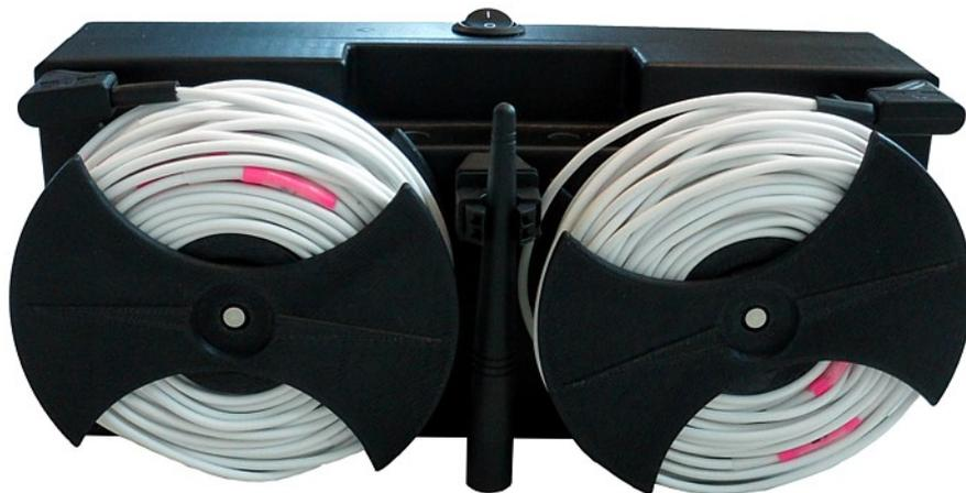
Abbildung 6.4: Spannungs-Kabeltrommeln montiert auf Controller
