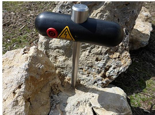
Abbildung 9.5: Bohren eines Lochs und Nachfüllen für die Elektrode
