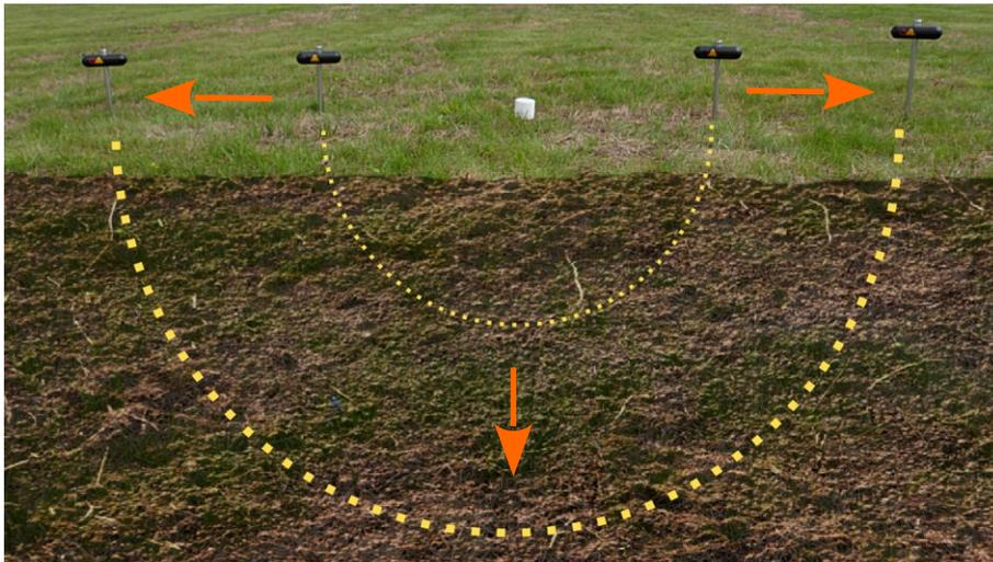
Abbildung 7.3: Strom-Einspeisung hängt vom Elektrodenabstand ab
