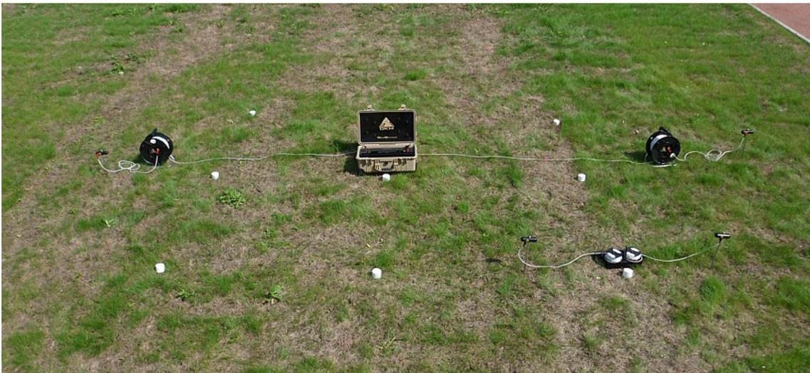
Abbildung 7.7: Anordnung der Elektroden während der Aktiven Messung (Schnell)
