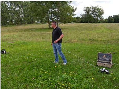
2. Rollen Sie das Kabel der ersten Spannungs-Kabeltrommel komplett ab, indem Sie es in einer geraden Linie auslegen.
