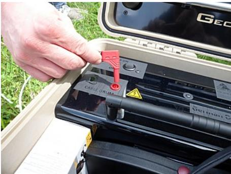
2. Verbinden Sie den Stecker der ersten Netzkabeltrommel mit der entsprechenden Steckdose der Power Box.
