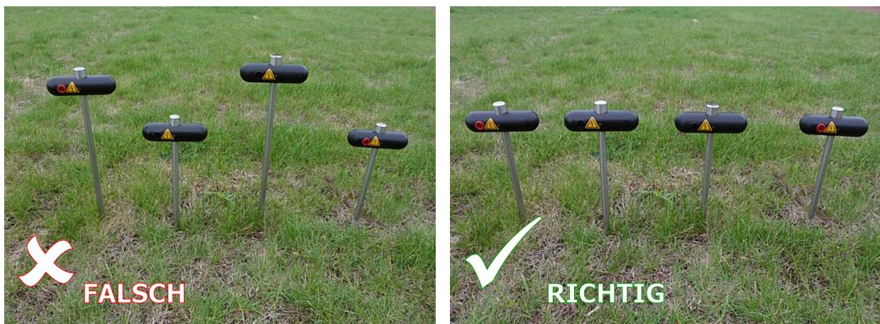
Abbildung 9.2: Elektroden müssen gleichmässig in den Boden eingebracht werden
