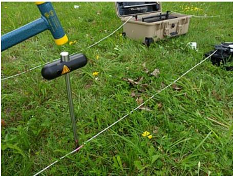
4. Stecken Sie die Spannungselektrode neben dem Kabelmarker so tief wie möglich in den Boden. Benutzen Sie ggf. einen Hammer.
