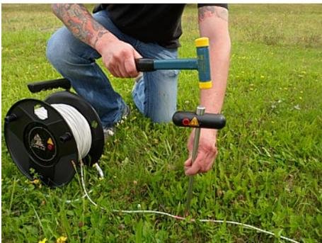
4. Stecken Sie die Power-Elektrode neben dem Kabelmarker so tief wie möglich in den Boden. Benutzen Sie ggf. einen Hammer.
