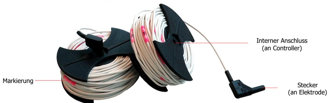
Abbildung 4.3: Bestandteile der Spannungs-Kabeltrommeln
