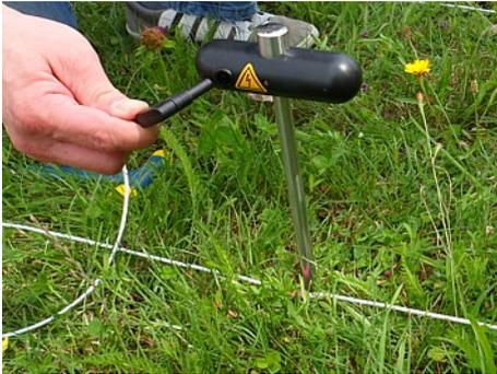
5. Verbinden Sie das Kabel der Spannungs-Kabeltrommel mit der Spannungselektrode.
