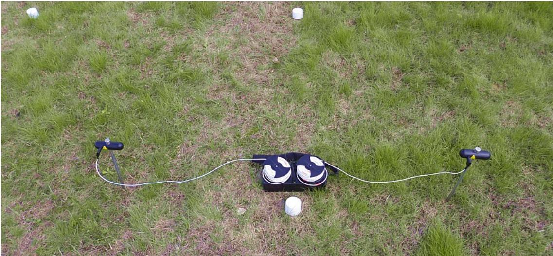
Abbildung 7.8: Anordnung der Elektroden während der Passiven Messung
