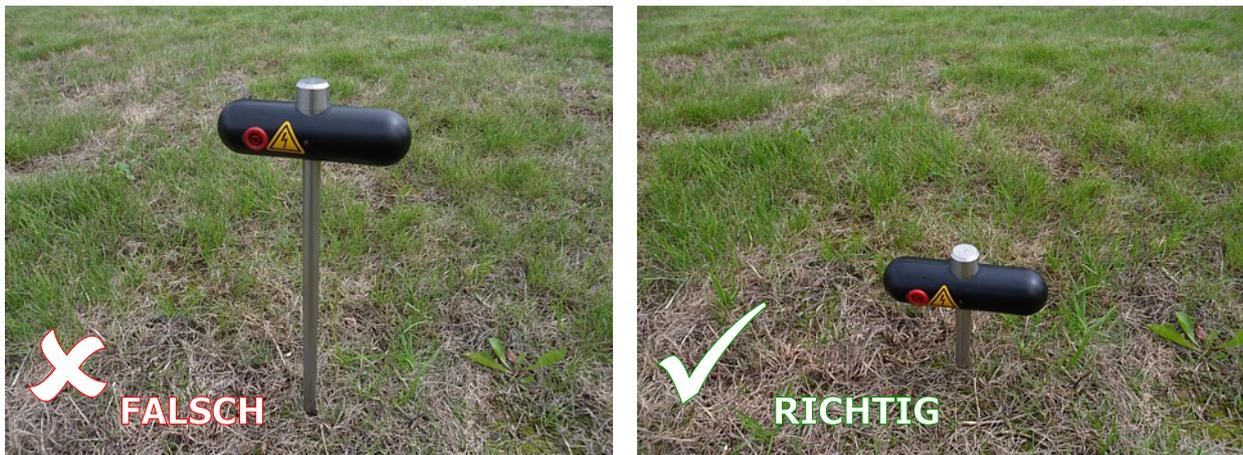
Abbildung 9.1: Elektroden brauchen guten Bodenkontakt
