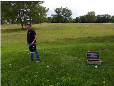
3. Rollen Sie das Kabel der Strom-Kabeltrommel ab, indem Sie sich von der Power Box entfernen, bis Sie die Kabelmarkierung erreichen, die von der Android App Ihres Tablet PCs angezeigt wird.
