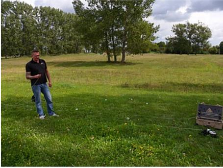
3. Nachdem Sie das Ende erreicht haben, machen Sie eine Kehrtwende und bringen Sie das Kabel zurück zu dem Kabelmarkierer, der durch die Anwendung Ihres Tablet PCs angezeigt wird. Das komplette Abrollen des Kabels ist notwendig, um die richtige Anordnung der Kabelmarkierungen zu erhalten und erleichtert das nachträgliche Umstellen der Elektroden.
