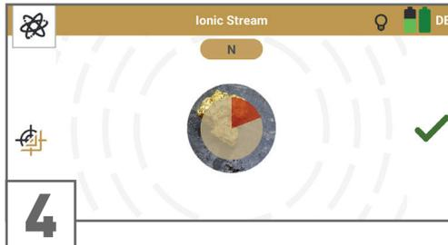
Bestätigen Sie mit dem Trigger oder durch Tippen auf
