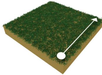
Gehen Sie bis zum Ende der ersten Messbahn. Drücken Sie den Trigger, sobald Sie das Ende der Bahn erreicht haben, um die Feldlänge für die folgenden Bahnen festzulegen.
