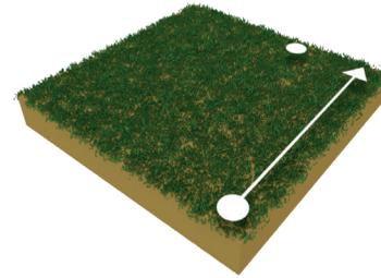
Bleiben Sie am Ende der Messbahn stehen und gehen Sie einen Schritt nach links (ohne zu messen). Halten Sie die Sonde weiterhin in dieselbe Richtung wie in der ersten Messbahn.
