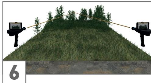
6 Führen Sie eine Kontrollmessung aus einer anderen Richtung durch. Der zweite Punkt sollte in einer Entfernung von 25 bis 500m von Ihrer ersten Position liegen.
