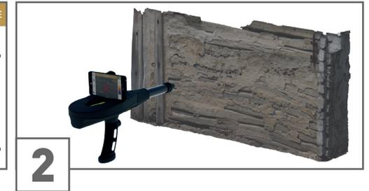
Richten Sie die Sonde auf ein Ziel (z.B. Wand). Überprüfen Sie die Position der Punktwolke, indem Sie auf das Laserpointer-Symbol
