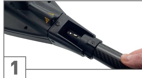
1 Stecken Sie den Sondenstecker in die Sondenbuchse. Achten Sie auf die richtige Position der Stifte!
