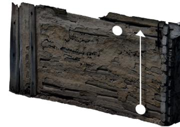
Halten Sie die Sonde auf den Endpunkt. Gehen Sie einen Schritt nach links (ohne zu messen). Die Sonde zeigt nun auf den nächsten Startpunkt.
