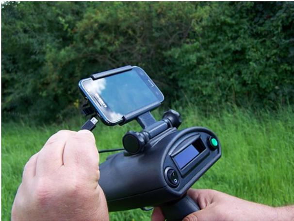
Figure 5.7: Brancher le câble USB de charge aux Smartphone
