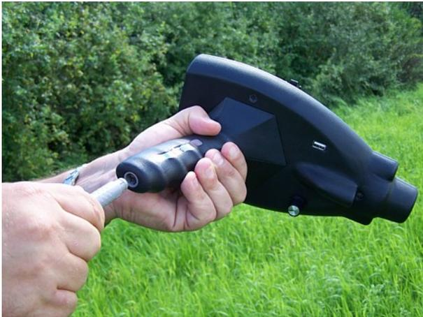
Figure 5.1: Connecter le Power Pack avec l'appareil
