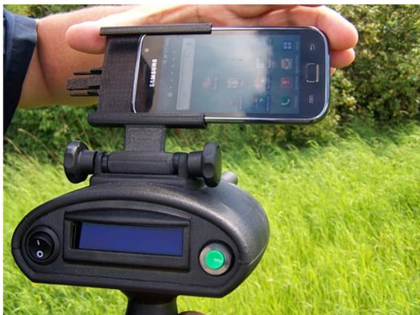
Figure 5.4: Glisser le Smartphone dans la fixation approprié
