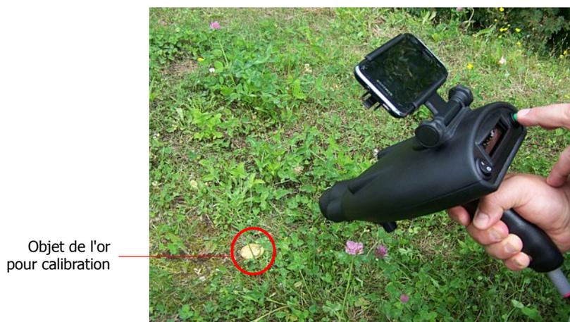
Figure 6.9: Calibration de l'appareil sur un objet de l'or dans le mode ionique
