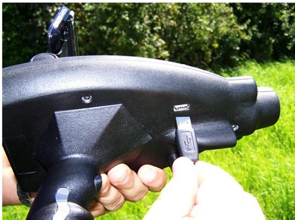
Figure 5.6: Brancher le câble USB à l'appareil
