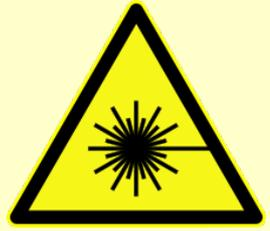
هذا الجهاز مجهز بليزر من الدرجة 3R وفقاً للمعيار الأوروبي EN 60 825-1:2007. لا تفتح الجهاز أبداً. لا يسمح بأعمال الضبط والصيانة إلا من قبل خبير مؤهل يعرف الأخطار الموجودة. أعمال ضبط الجهاز الغير صحيحة يمكن أن تؤدي إلى انبعاث إشعاعات الليزر الخطيرة.
