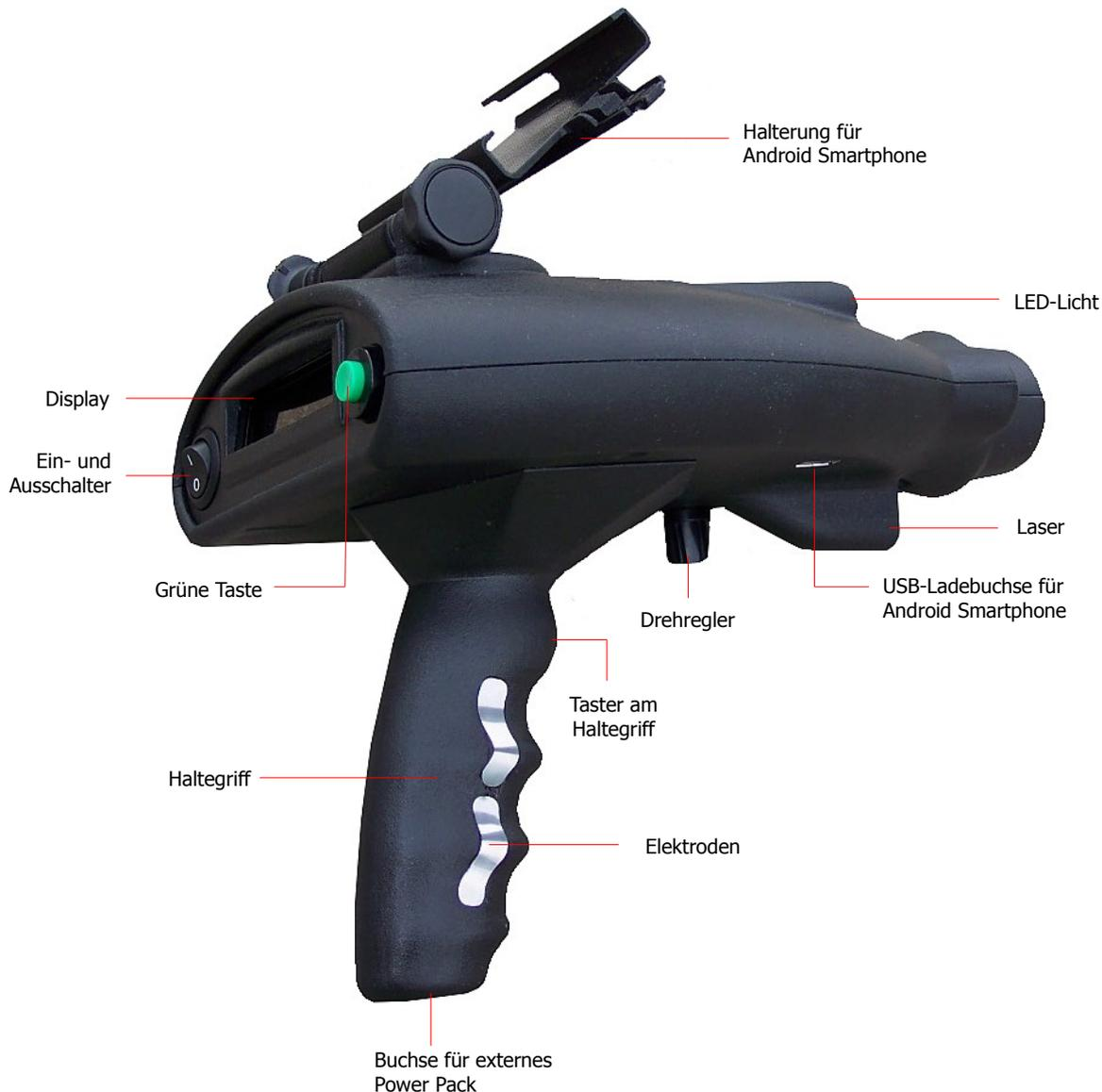
Abbildung 4.1: Bedienelemente des Bionic X4
