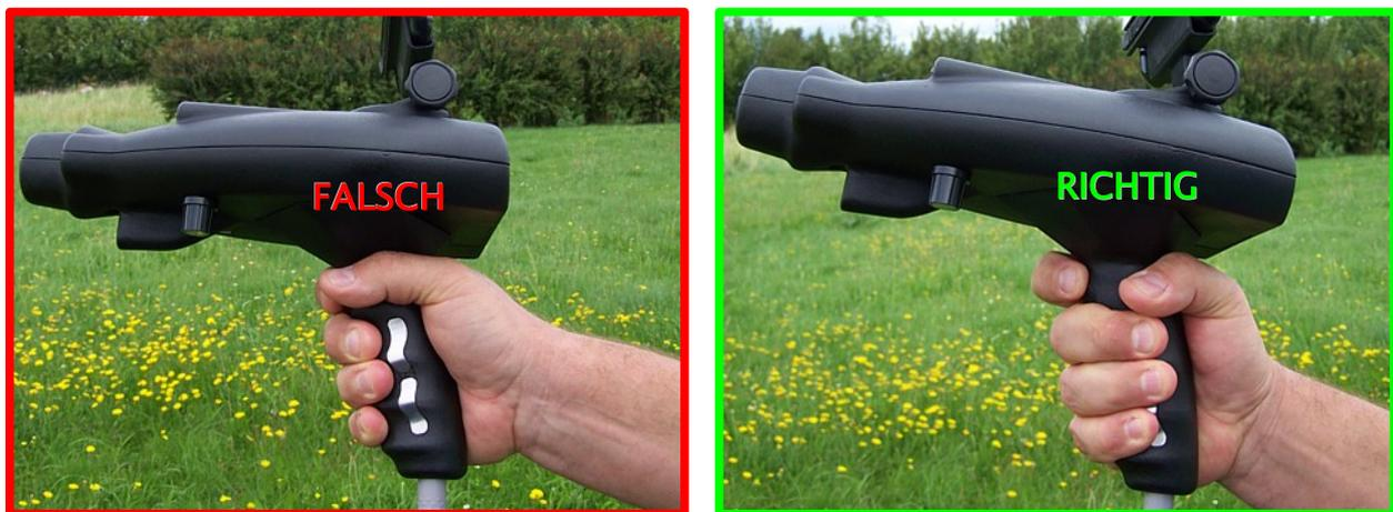
Abbildung 6.2: Kontakt mit den Elektroden
