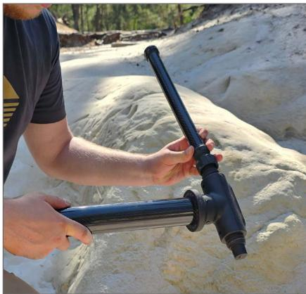
Für Messungen in engen Passagen wie Höhlen, Felsspalten und in Wäldern ist die einzelne Supersonde ideal geeignet. Diese lässt sich um bis zu vier Module, so genannte *Enhancer*, zum PentaSense-System erweitern. Damit sind drei Sensor-Konfigurationen für verschiedene Messumgebungen möglich. Diese Flexibilität bietet eine schnelle Anpassung an vielfältige Einsatzgebiete.
