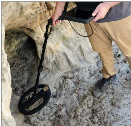
Die *PentaCoil* nutzt VLF (Very Low Frequency) und ermöglicht die präzise Ortung von Metallobjekten mittels elektromagnetischer Impulse. Diese Technologie ist besonders effizient, um Münzen und Schmuck in Oberflächennähe zu detektieren. Außerdem können Objekte aus Edelmetallen wie Gold und Silber von Artefakten und Militaria-Fundstücken aus Eisen unterschieden werden.
