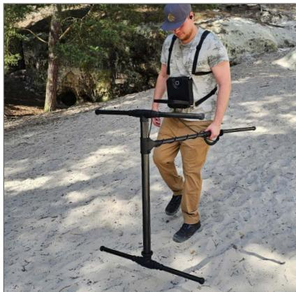
*PentaSense* ist ein Multi-Sensor-System, bei dem gleichzeitig fünf Sensorenpaare parallel den Untergrund messen. Diese Konfiguration deckt einen breiten Flächenbereich ab und eignet sich somit ideal für die Erkundung großflächiger Areale. Diese Technologie ermöglicht präzise 3D-Bodenuntersuchungen, um Artefakte, Relikte und Schatzkammern in bis zu 25m Tiefe zu lokalisieren.
