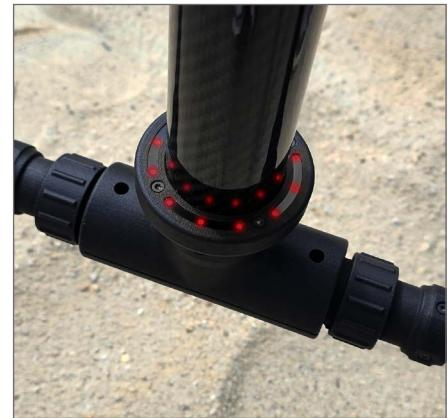
Die Supersonde des OKM eXp 5500 ist mit einem 360° LED-Orbit zur visuellen Lokalisierung von vergrabenen Schätzen ausgestattet. In der Betriebsart *Magnetometer* setzen die LEDs die aktuellen Messwerte in ein Farbspektrum um, damit potenzielle Funde in Echtzeit angezeigt werden. Im *3D Ground Scan* dient der LED-Orbit als Taktgeber, um Messungen gleichmäßiger durchführen zu können.
